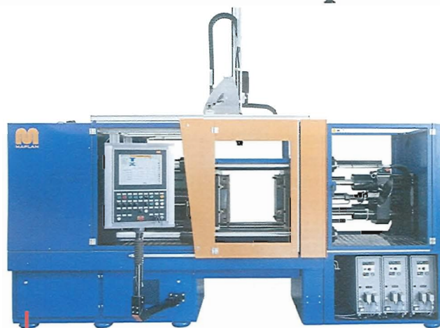
La presse MHF200/300E2 était équipée d'un nouveau système de brosse hydraulique capable d'appliquer une importante force d'égrappage des pièces.
