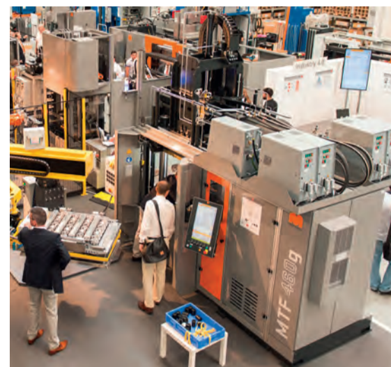
Das Bild zeigt Exponat #5 – MTF 4000R / 460 G – 4-Holm-Vertikalmaschine mit auf der oberen Maschinenplatte positioniertem Großvolumen-Plastifizieraggregat kombiniert mit einem vertikalen Einspritzmodul.
