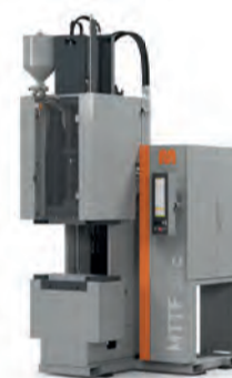
#2: MTTP85 / 30 C – TPE Verarbeitung mit bewährter MAPLAN C-Rahmen Technologie.
