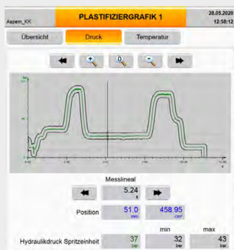
Abb.2: Druckverläufe mit generierter Hüllkurve zur Toleranzüberwachung
