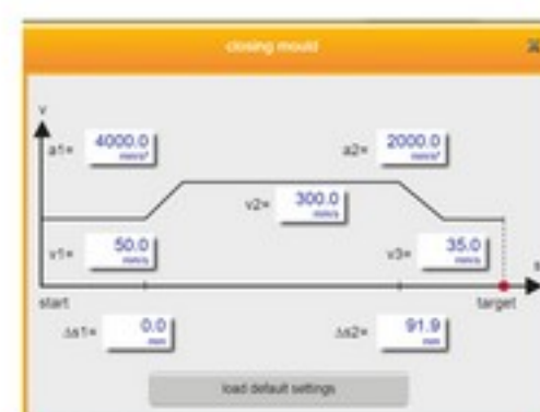
Abb 1: Einstellmöglichkeiten für die Fahrgeschwindigkeit beim Schließen. Hier: Automatisches Anfahren bis zur eingestellten Maximalgeschwindigkeit, automatisches Bremsen bis Schließgeschwindigkeit 40,0.
