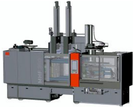
Hydraulische Horizontalmaschine Rapid 700D/300 in Kombination mit Stopfvorrichtung zur Verarbeitung von HTV-Silikon und einem servoelektrisch angetriebenen Doppelbürstensystem zur automatischen Teileentformung. (Abb.: Maplan)
