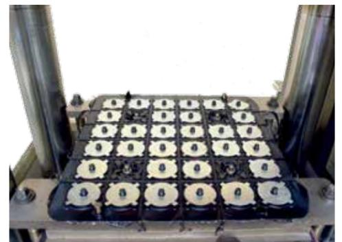
EMV Gummiteile, produziert auf einer MAPLAN-Spritzgießmaschine im Pressprozess
