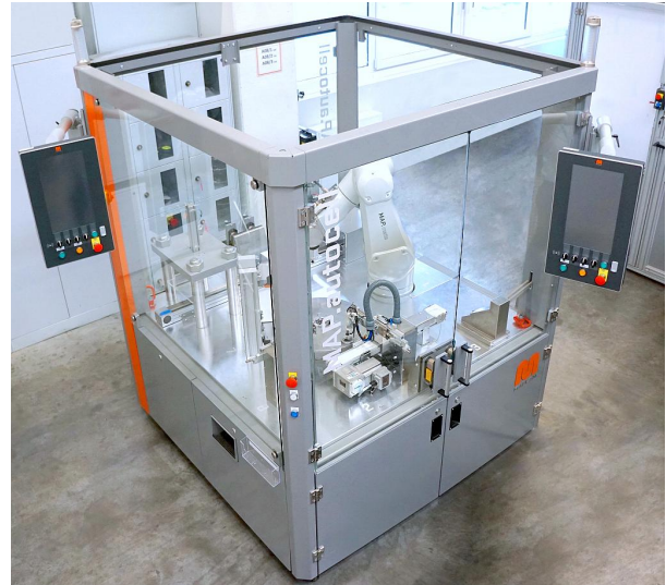
Beispiel eines MAP.autocell-Grundmoduls, der entweder im Stand-Alone-Betrieb oder in Kombination mit einer Spritzgießmaschine oder weiteren Modulen betrieben werden kann. (Foto: Maplan)
